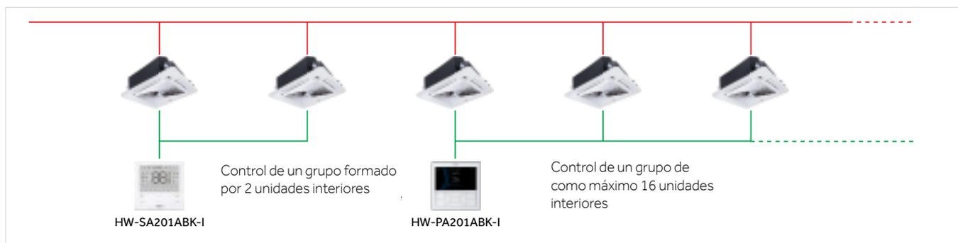
Ejemplo de conexión de módulo Wi-Fi para el manejo independiente de cada unidad interior
