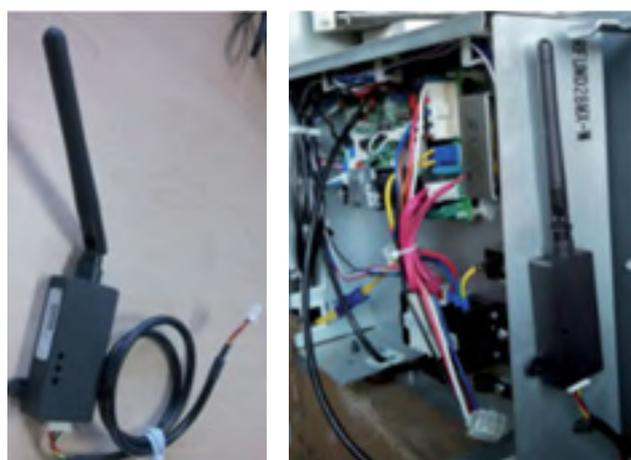
Adaptador de radio para la unidad interior que se conecta a la tarjeta electrónica correspondiente.
