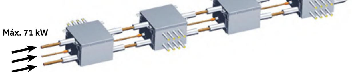
\* El límite viene determinado por los diámetros de los tubos de entrada a las cajas de válvulas.
