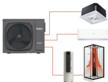
Szenario 2: Häusliches Warmwasser + AC Heizung
