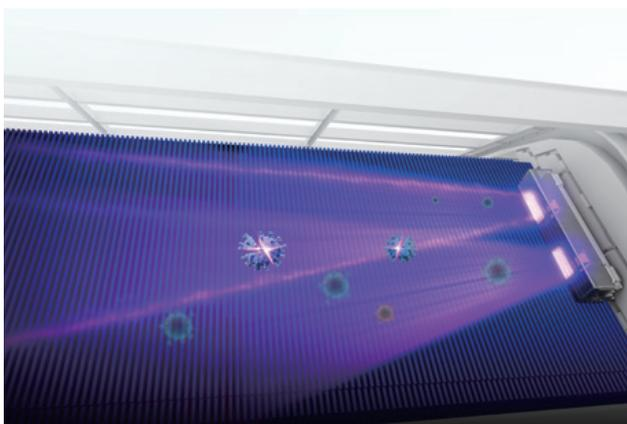
La lampe émet de la lumière sur deux longueurs d'onde différentes dans la gamme des UV (à 254 nm et 172 nm), appelées « rayons UV sous vide », offrant ainsi une double efficacité en purifiant l'air à la fois avec les rayons UVC et les radicaux hydroxyles produits par photolyse.
