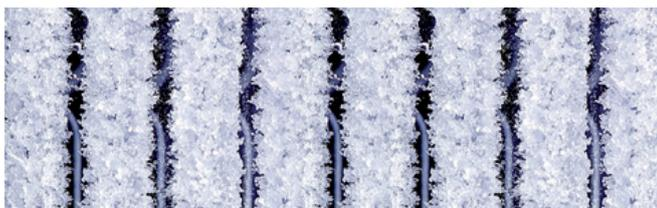
La couche de gel qui se forme sur l'évaporateur/le condenseur génère une puissante force d'expansion du froid qui élimine facilement la saleté sur la surface.
