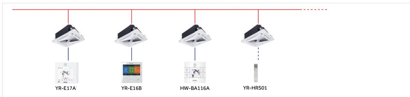
Exemple de contrôleur de groupe (seulement pour les commandes filaires - 16 unités intérieures max sur un seul contrôleur)
